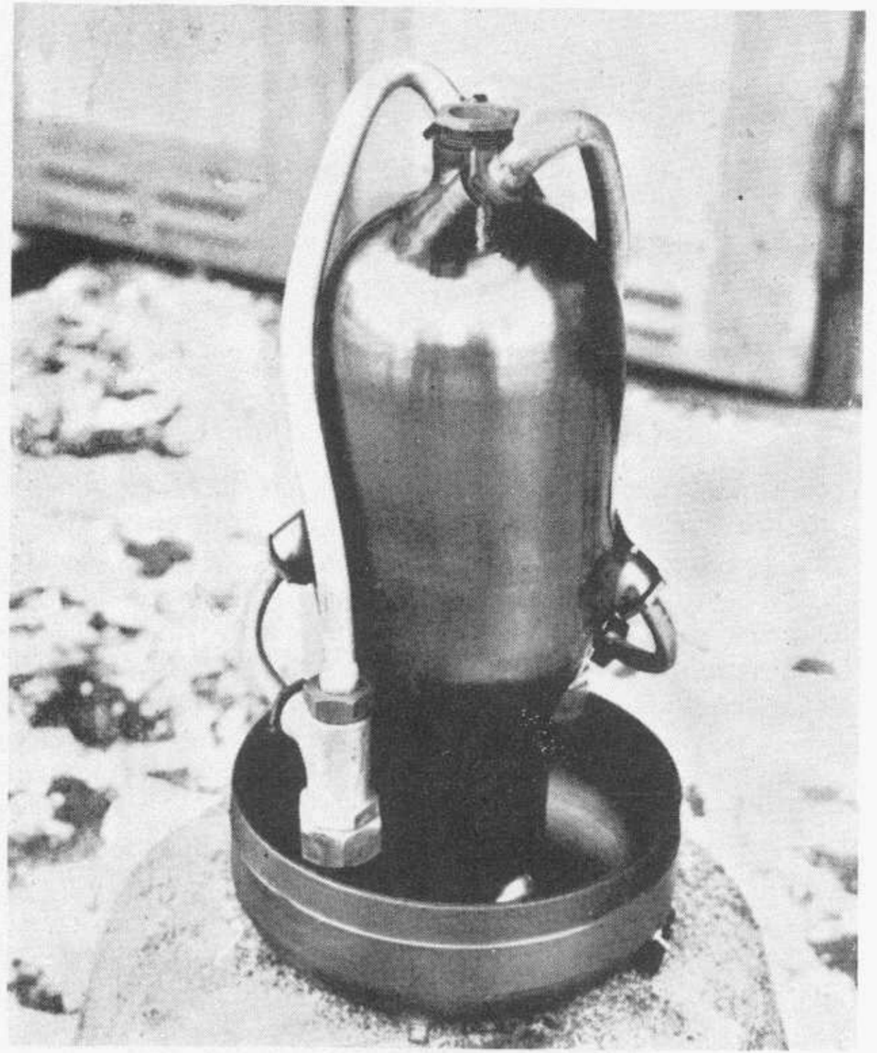
Photo 9: Der 2-B-Ofen mit automatischen Brennstoffhähnen und Tankschlußdeckel, einbaufertig für das Aggregat
